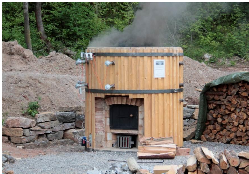
Obr. 1 Funkční vzorek vápenné pece pro malovýrobu vápenných pojiv
