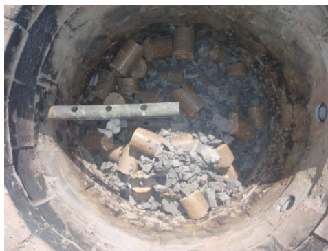
Obr. 4. Směsné plnění vápence a dřevěných briket v poměru 3:1 váhově.
