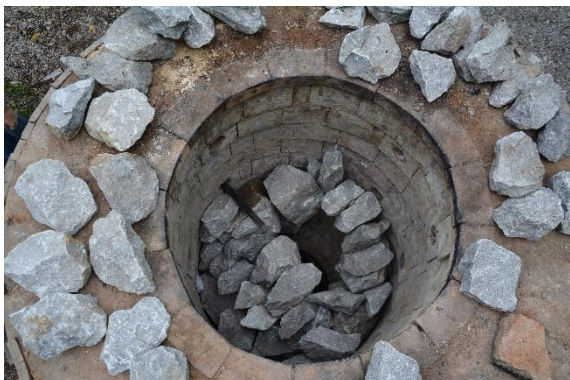
Obrázek 1 – 1. Plnění pece - stavba klenby – vytvoření prostoru topeniště.
