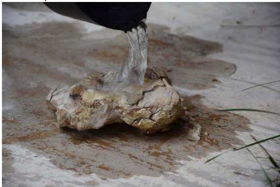
Obrázek 1 – 3. Zkouška hašení vzorku vypáleného vápna.
