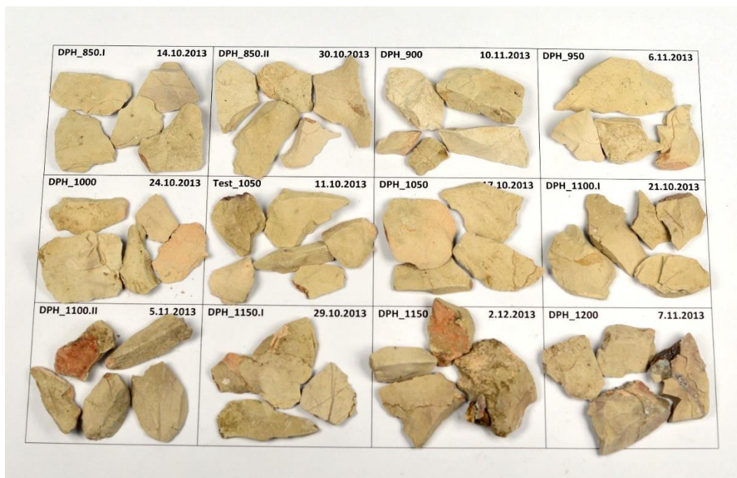
Obrázek 5. Srovnání barvy přirozeně hydraulického vápna po výpalu od 850 do 1200°C.
