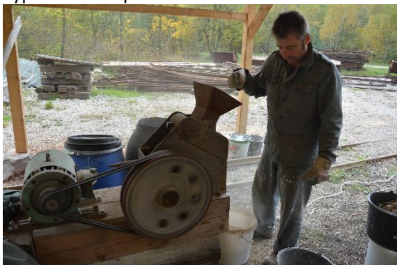
Obrázek 1 – 5. Drcení páleného vápna v čelistovém drtiči.
