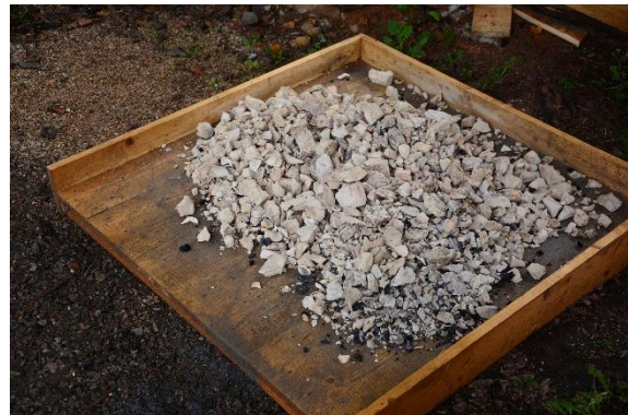
Obrázek 1 – 4. Vypálené hydraulické vápno před drcením.
