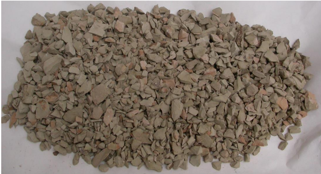
Obrázek 1. Vzorek přirozeně hydraulického vápenného pojiva, frakce 4-15 mm.
