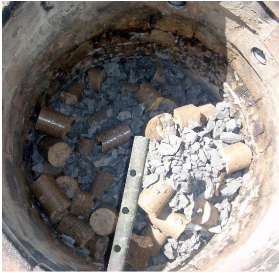
Obrázek 1 – 1. Plnění pece směsí dvorecko-prokopského vápence frakce 20 – 60 mm a dřevěných briket.
