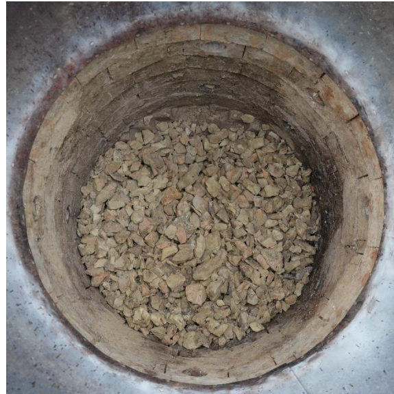
Obrázek 1 – 2. Pohled do pece shora při vybírání vypáleného vápna.
