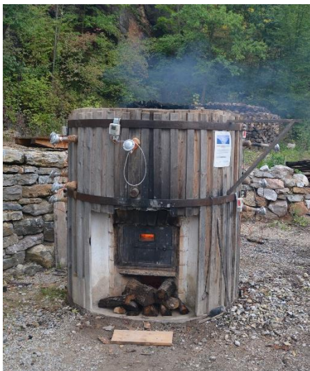
Obr. 4: Experimentální pec v Solvayových lomech. Při jednorázovém výpalu lze získat 500 kg páleného kusového vápna. Graf vlevo ukazuje průběh teploty během výpalu ve středu pece nad klenbou. Za přibližně 15 h bylo dosaženo 900 °C a výpal trval dalších 15 hodin.
